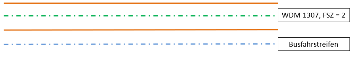
Abbildung 34: Modellierung eines durch Fahrbahnmarkierung getrennten Busfahrstreifens
