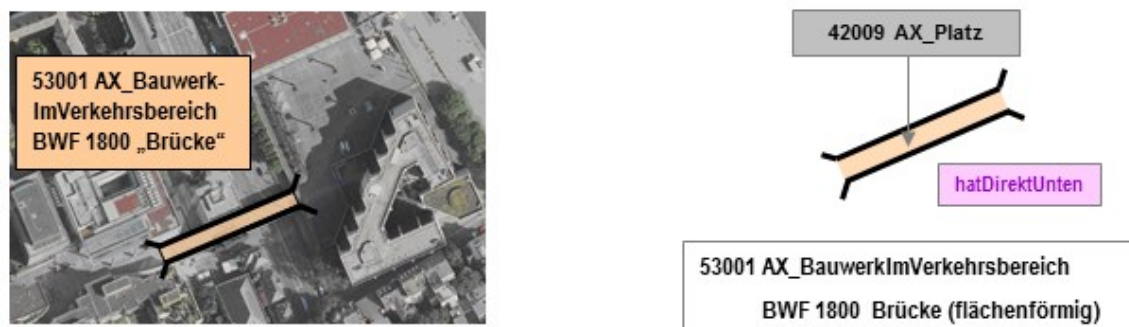
Abbildung 49: Modellierung einer flächenförmigen Brücke mit einem flächenförmigen Objekt
