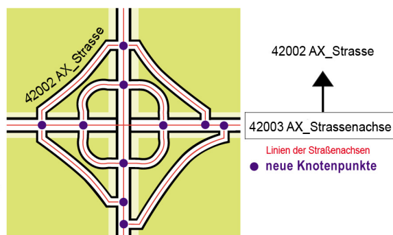
Abbildung 5.4 – 11. : Herstellung der Topologie bei der Umwandlung von physisch getrennten zu einfach modellierten Straßen
