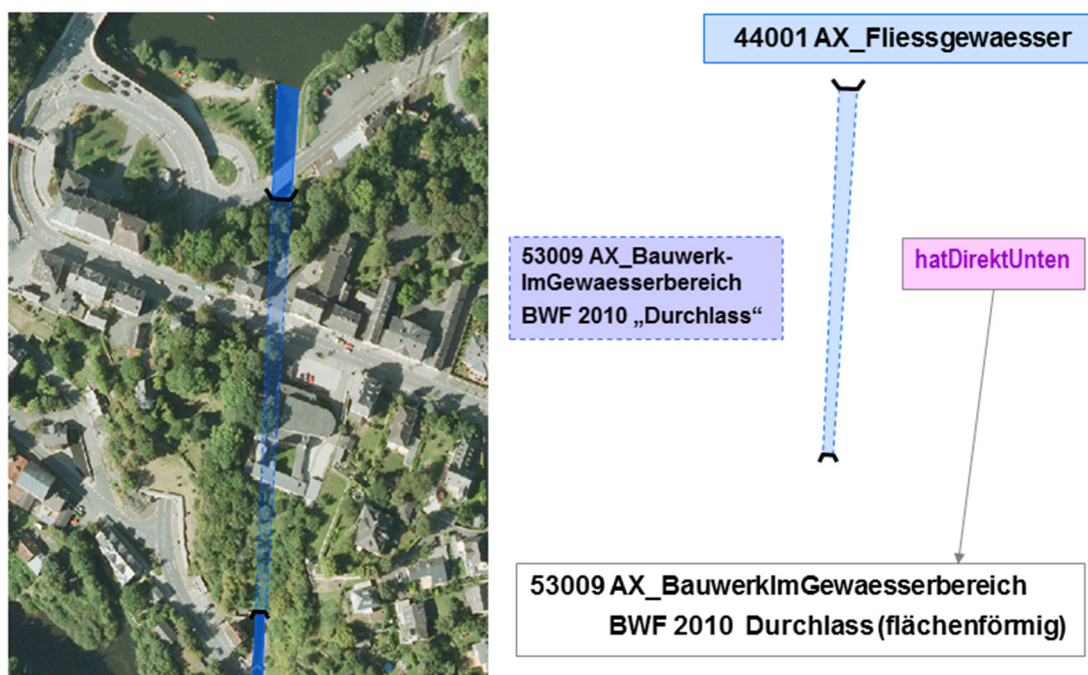
Abbildung 53: Modellierung eines flächenförmigen Durchlasses mit einem flächenförmigen Objekt
