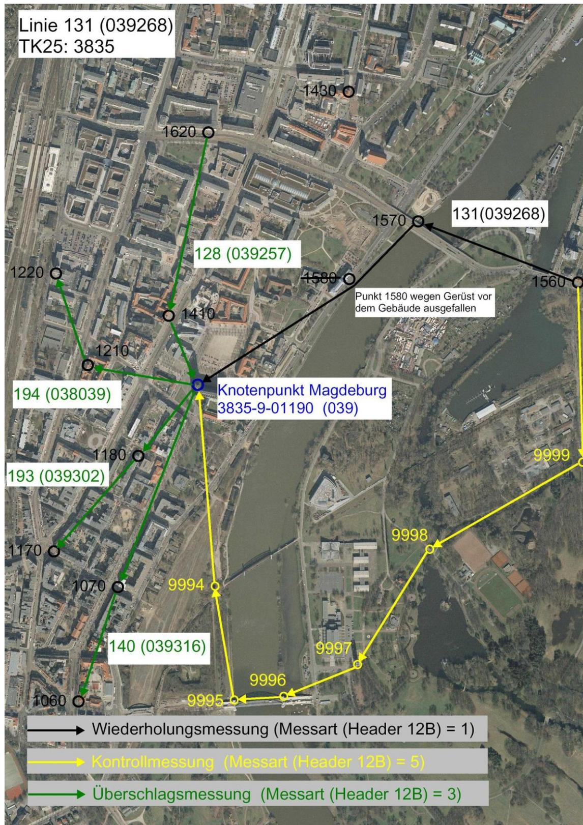
Abb. J-4: Überschlagsmessung und Kontrollschleife am Knotenpunkt
