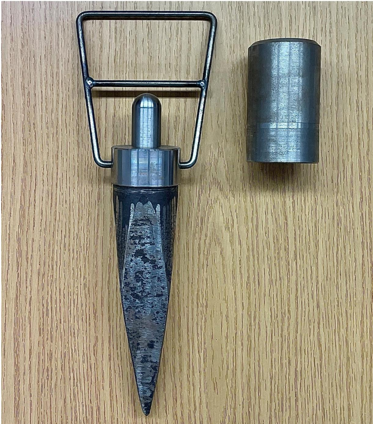
Abb. D-5: Bodenbolzen und Schlagkappe
