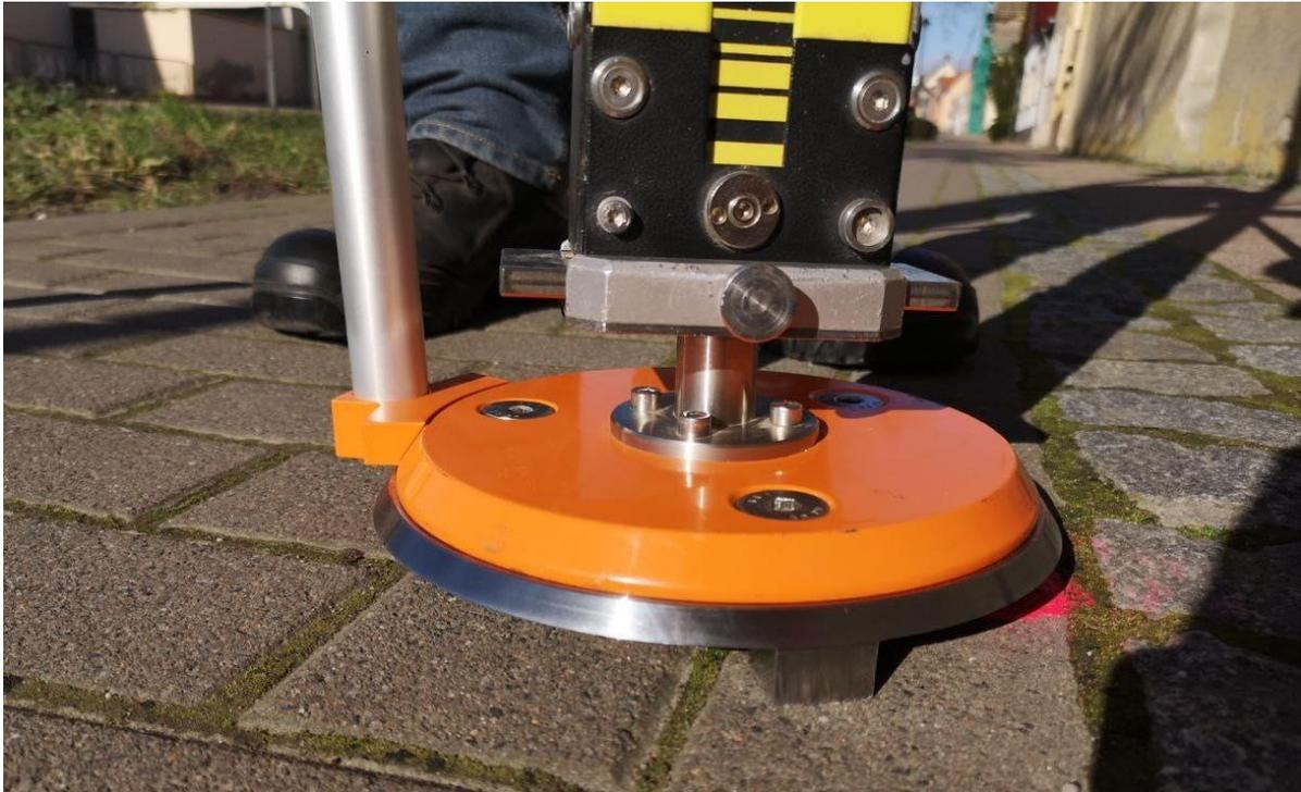
Abb. D-4: Nivellierplatte mit breiter Aufsatzfläche, Lattenschuh und schwerem Frosch
