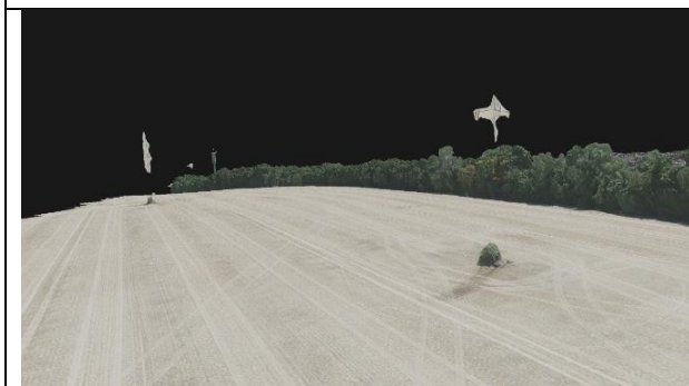
Abbildung 4: Fehlende Strommasten, Stromleitungen
