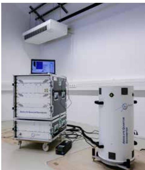
Abb. 9: Quantengravimeter AQQ Quelle: Uwe Hessels, BKG
