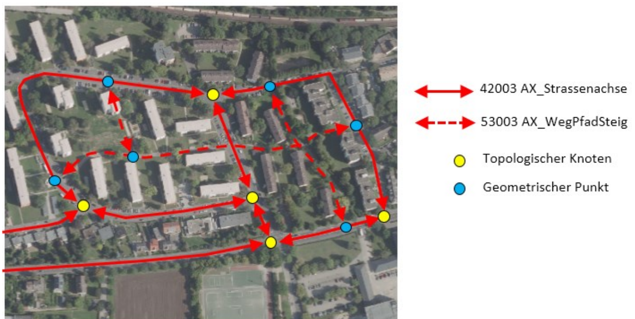
Abbildung 58: Modellierung von „Weg, Pfad, Steig“ mit Straßenachse
