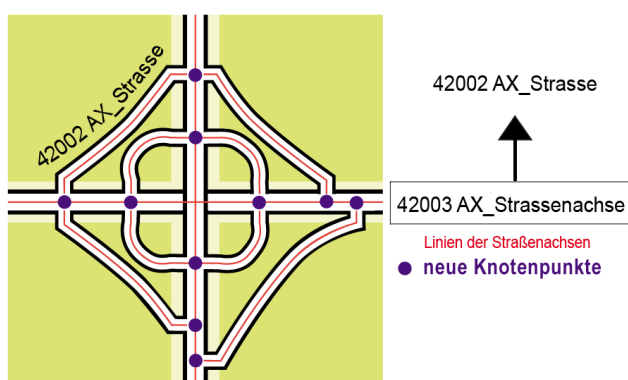
Abbildung 23: Herstellung der Topologie bei der Umwandlung von physisch getrennten zu einfach modellierten Straßen
