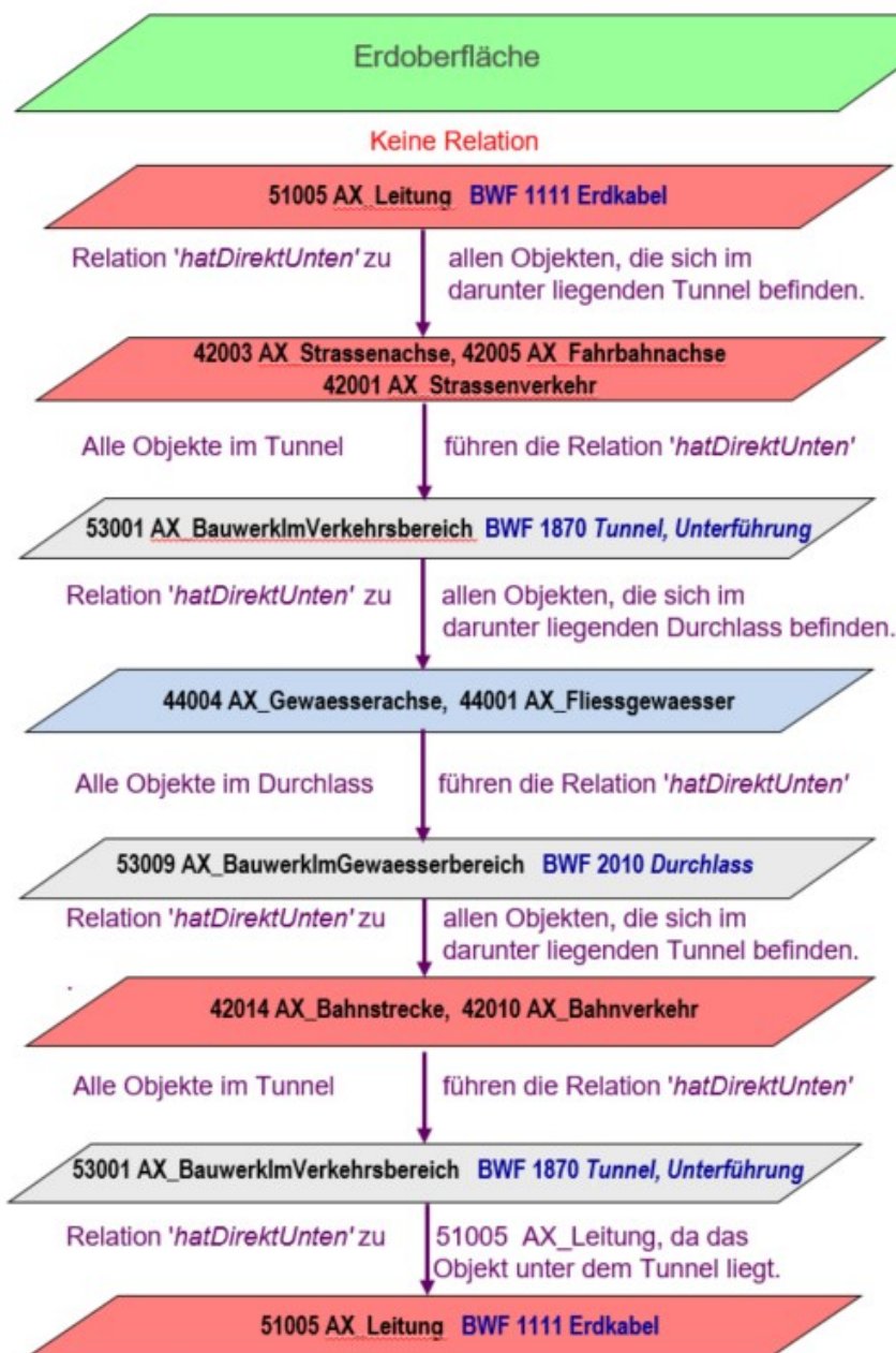
Abbildung 21: Vertikale Abbildung der Landschaft unter der Erdoberfläche
