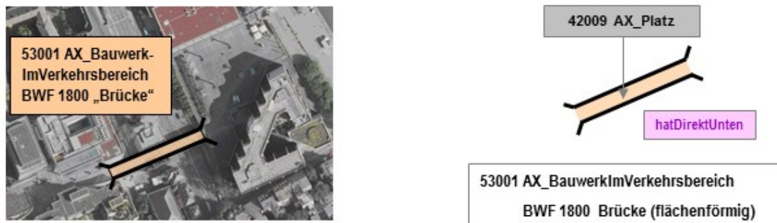
Abbildung 53: Modellierung einer flächenförmigen Brücke mit einem flächenförmigen Objekt
