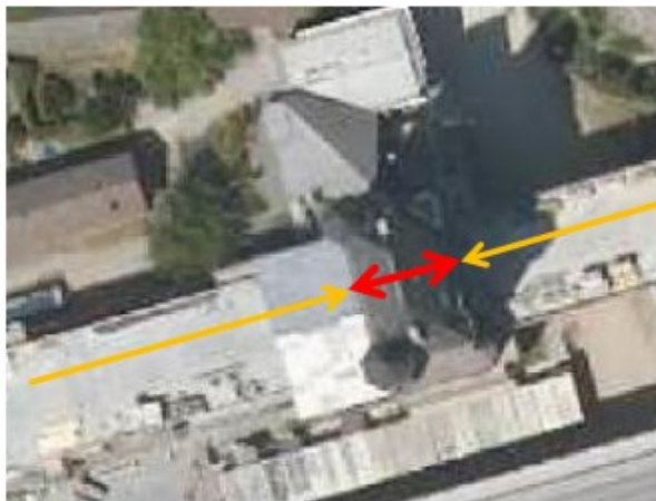
Abbildung 58: Modellierung einer linienförmigen Durchfahrt
