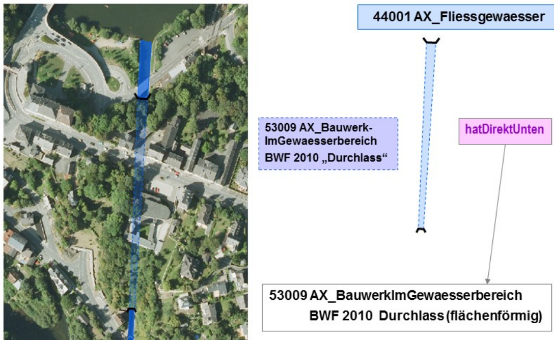
Abbildung 63: Modellierung eines flächenförmigen Durchlasses mit einem flächenförmigen Objekt
