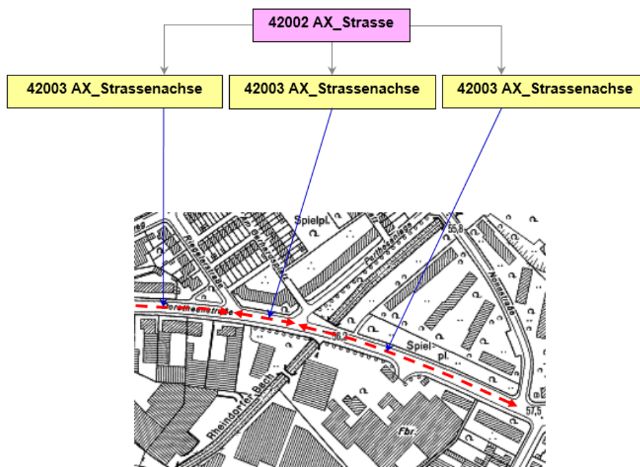
Abbildung 31: ZUSO AX_Strasse besteht aus 3 REO AX_Strassenachse
