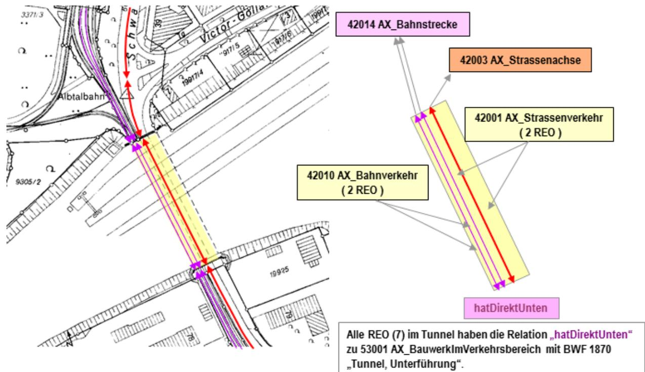
Abbildung 46: Modellierung eines flächenförmigen Tunnels mit mehreren Objekten
