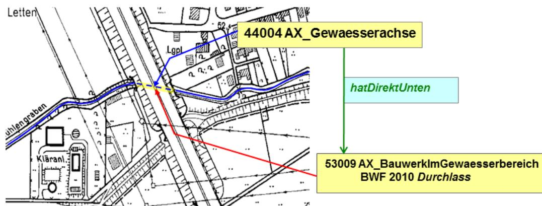
Abbildung 11: Beispiel für die Modellierung eines Durchlasses
