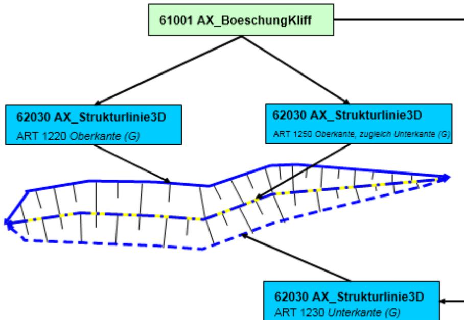
Abbildung 55: Modellierung einer Böschung mit Strukturlinien3D und Gefällewechsel
