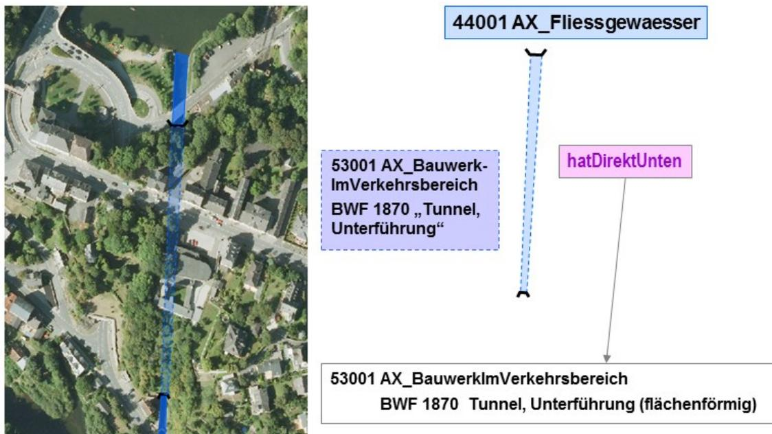
Abbildung 45: Modellierung eines flächenförmigen Tunnels mit einem flächenförmigen Objekt
