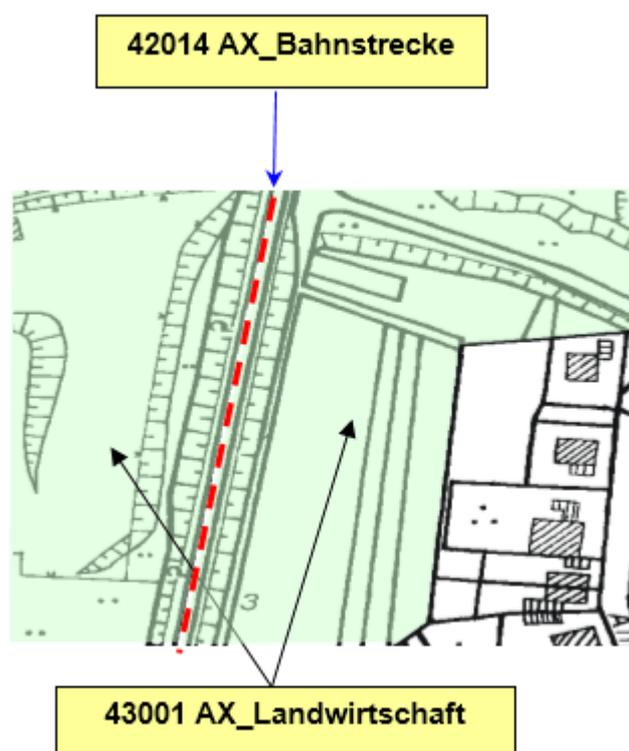
Abbildung 34: Modellierung einer Bahnstrecke
