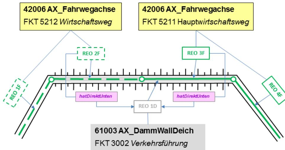
Abbildung 56: Modellierung eines linienförmigen Damms mit mehreren Fahrwegachsen
