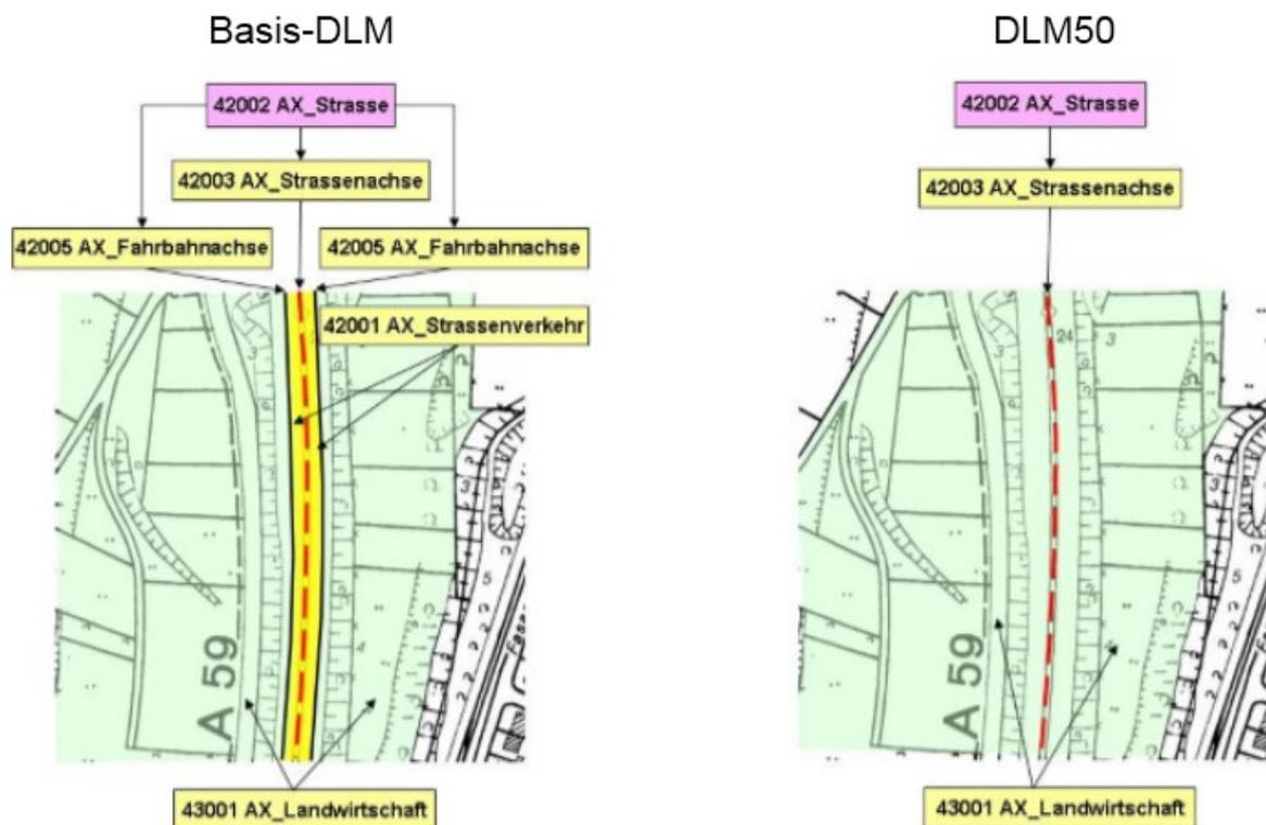
Abbildung 31: Modellierung einer Straße mit physisch getrennten Richtungsfahrbahnen im Basis-DLM und DLM50
