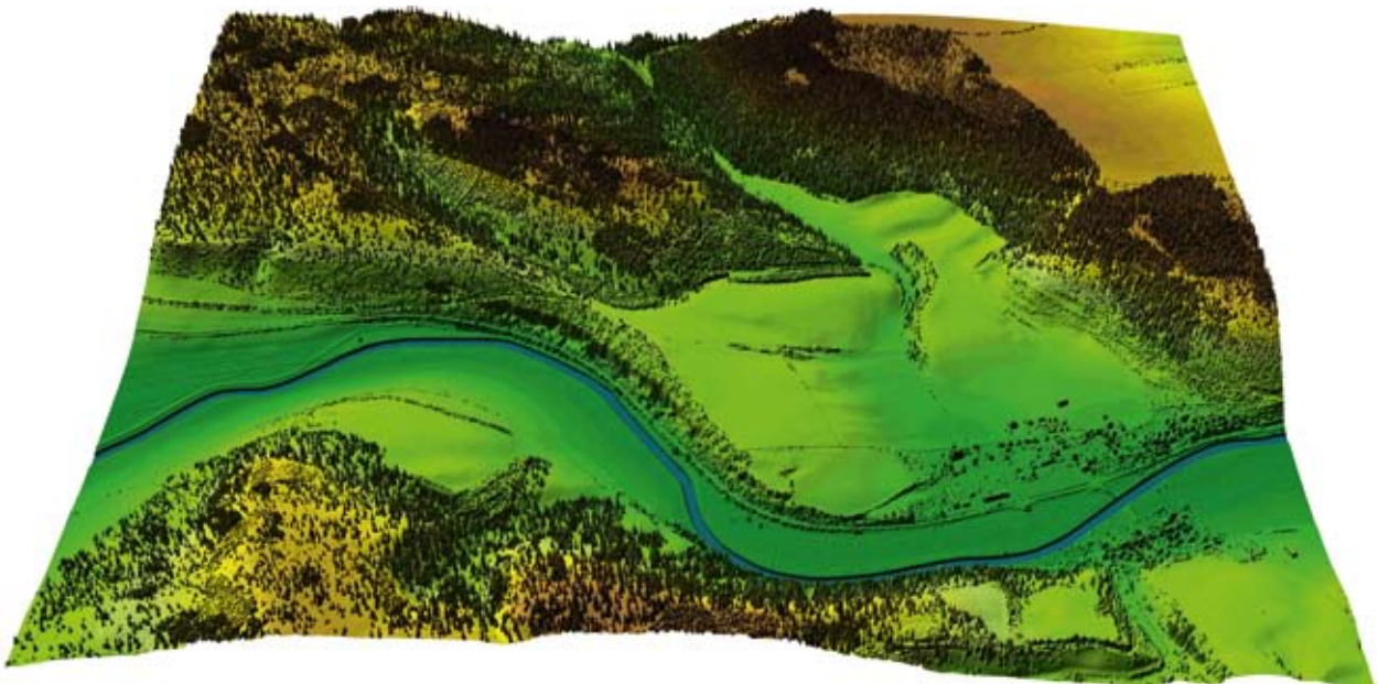
Abb. 13 DOM als 3D-Perspektivdarstellung in Pseudofarbcodierung (Ausschnitt Wangen Mittelberg)
