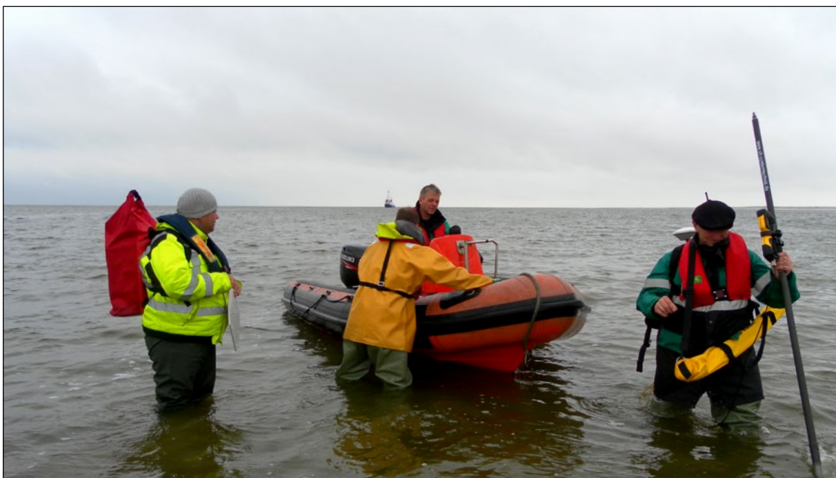
Abb. 7: Das Relativgravimeter wird wasserdicht verpackt zum nächsten Messpunkt transportiert.
