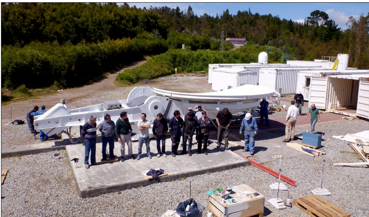
Abb. 4: Das Radioteleskop ist „zusammengefaltet“ und für die Verstaueung vorbereitet.
