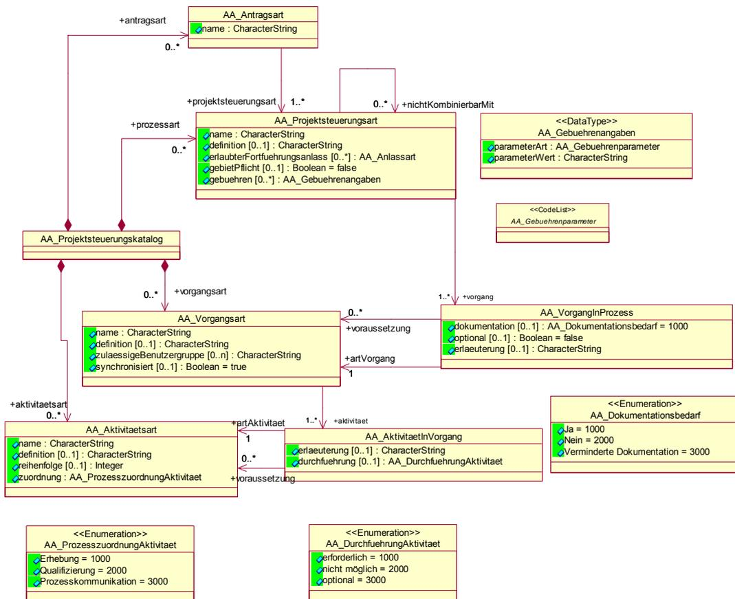
Figure 38: "AA\_Projektsteuerungskatalog" (project control catalogue) class diagram
