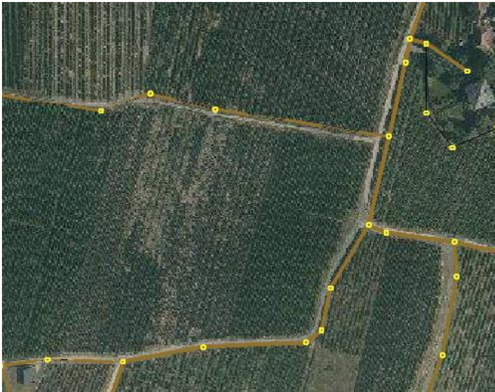
Abbildung 10: Beispiel für Lageabweichungen zwischen Modell und Örtlichkeit
