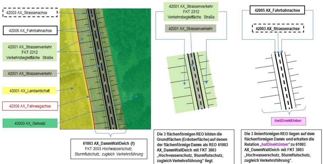
Abbildung 64: Modellierung eines flächenförmigen Damms mit Straßen- und Fahrbahnachsen
