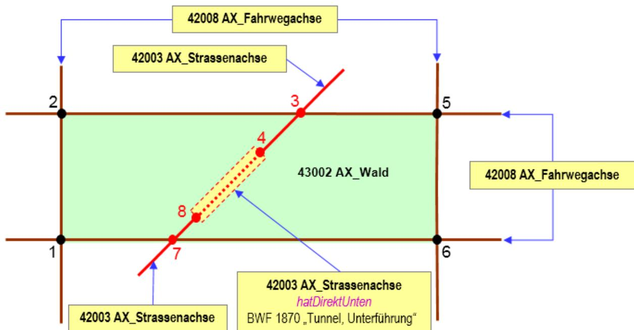
Abbildung 29: Durch „Tunnel“ unterbrochene „Maschenbildner“
