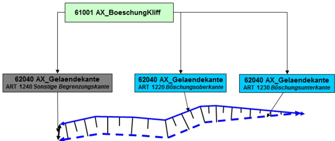
Abbildung 61: Modellierung von Böschungen mit Geländekanten
