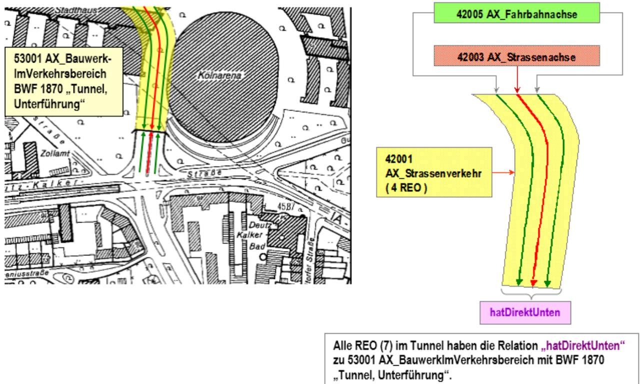
Abbildung 50: Modellierung eines flächenförmigen Tunnels mit mehreren Objekten
