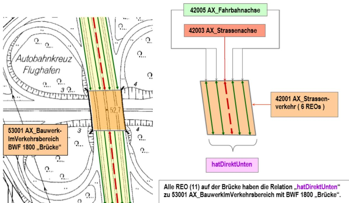
Abbildung 47: Modellierung einer flächenförmigen Brücke mit mehreren Objekten
