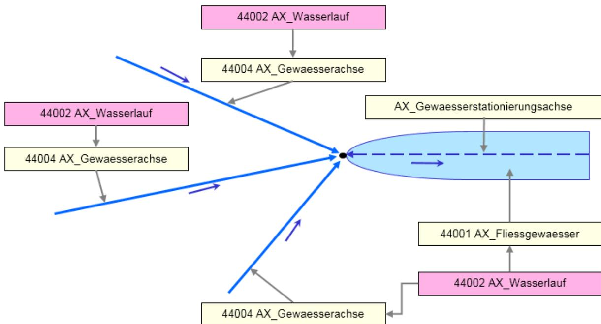
Abbildung 42: Modellierung von Wasserläufen unter Beachtung der Fließrichtung
