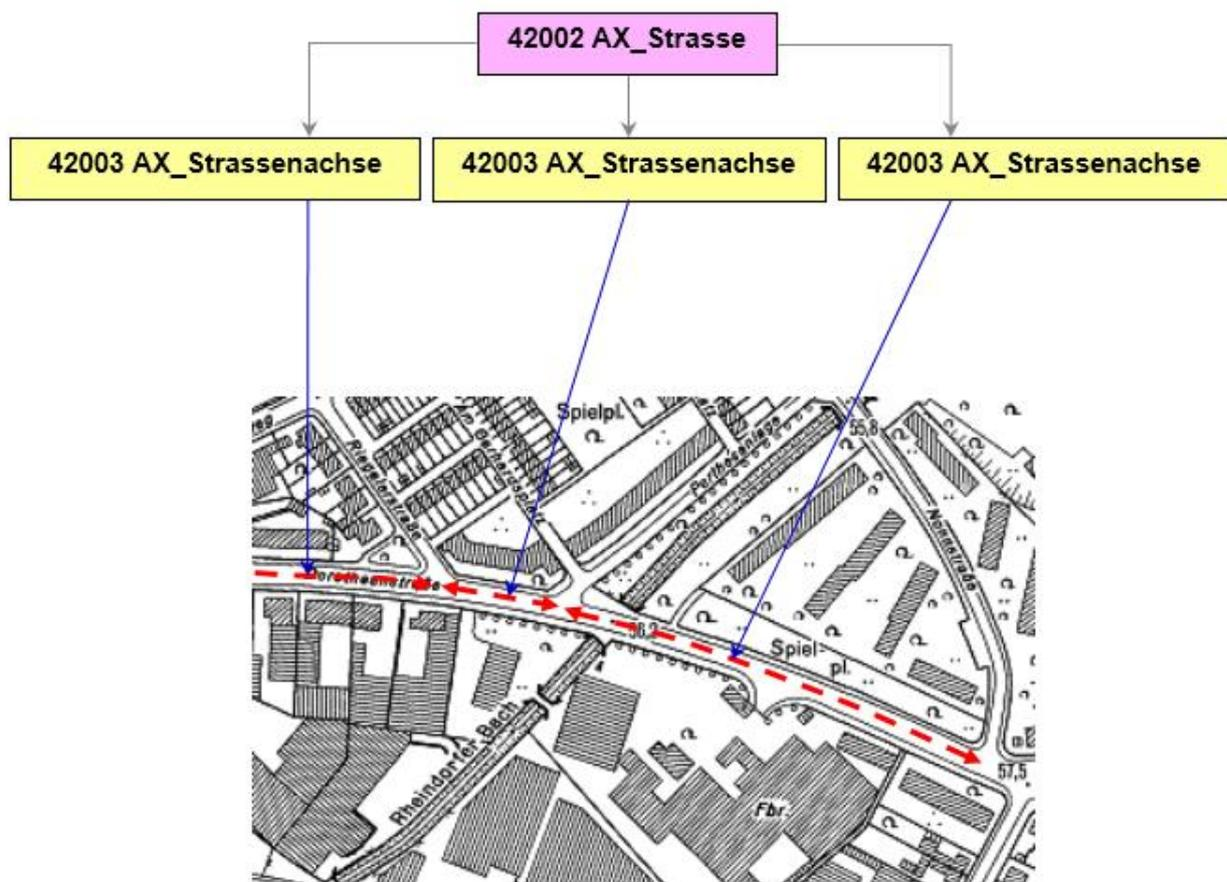
Abbildung 33: ZUSO AX\_Strasse besteht aus 3 REO AX\_Strassenachse
