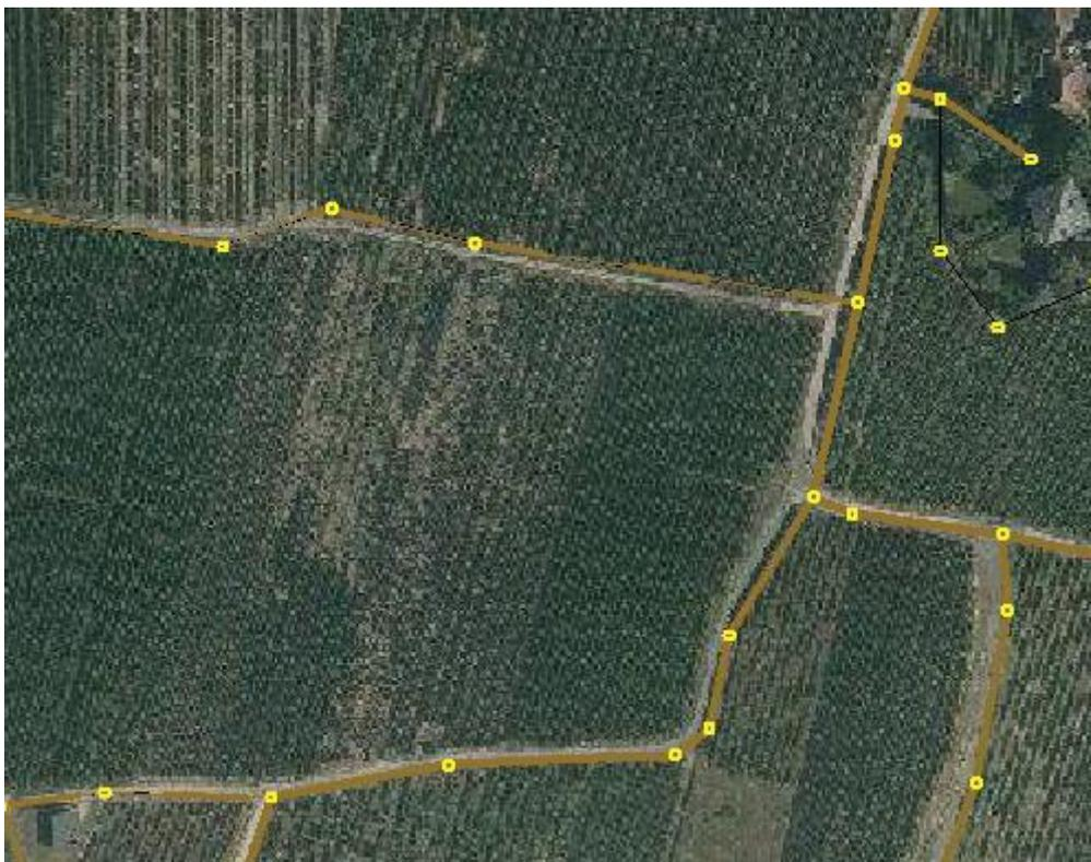
Abbildung 10: Beispiel für Lageabweichungen zwischen Modell und Örtlichkeit
