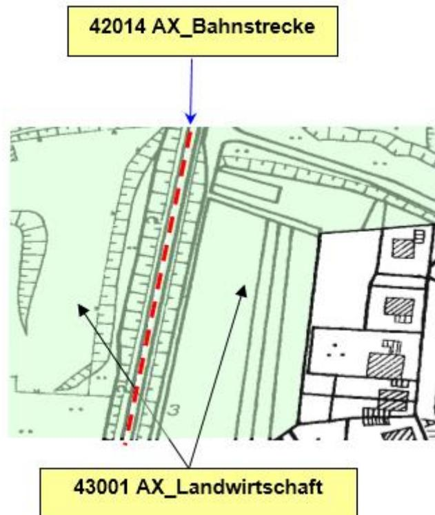
Abbildung 38: Modellierung einer Bahnstrecke
