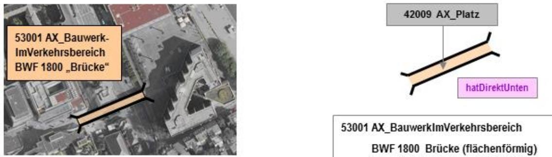
Abbildung 46: Modellierung einer flächenförmigen Brücke mit einem flächenförmigen Objekt
