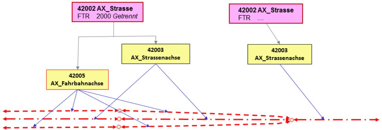
Abbildung 36: Modellierung eines „Übergangs“ physische Trennung in nicht-physische Trennung
