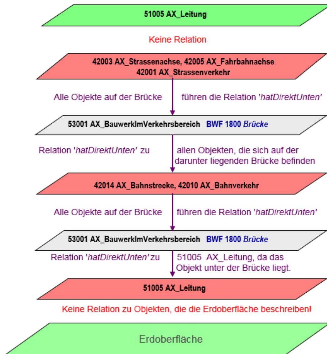
Abbildung 16: Vertikale Abbildung der Landschaft über der Erdoberfläche
