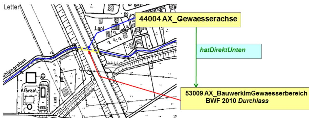
Abbildung 15: Beispiel für die Modellierung eines Durchlasses
