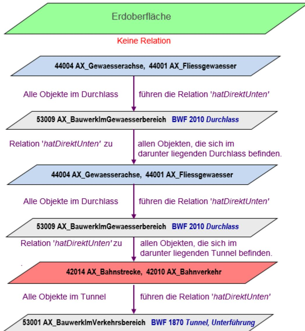
Abbildung 18: Vertikale Abbildung der Landschaft unter der Erdoberfläche
