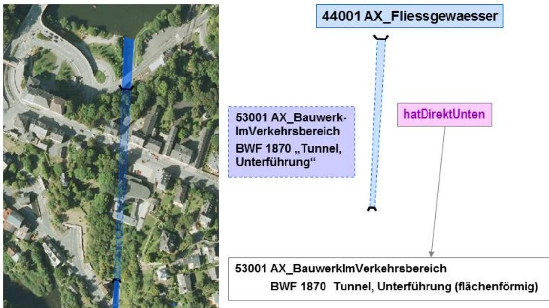
Abbildung 49: Modellierung eines flächenförmigen Tunnels mit einem flächenförmigen Objekt
