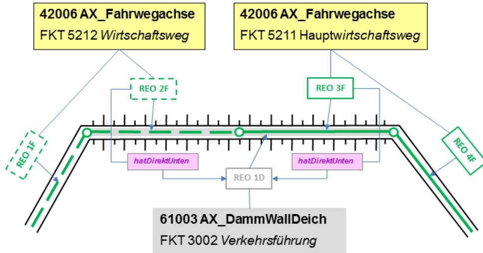
Abbildung 63: Modellierung eines linienförmigen Damms mit mehreren Fahrwegachsen
