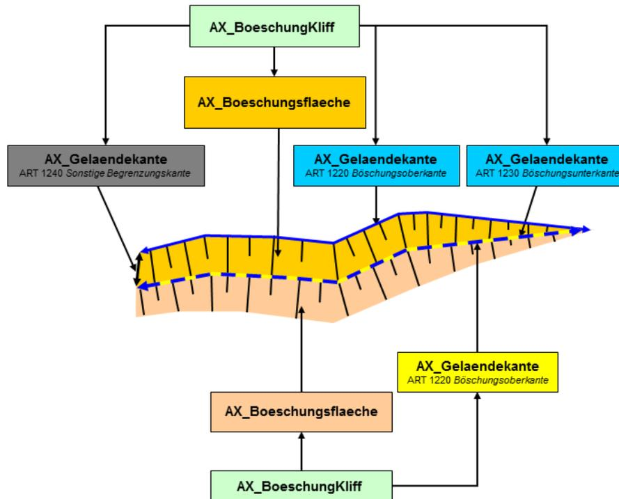
Abbildung 62: Modellierung von Böschungen mit Böschungsflächen und Geländekanten
