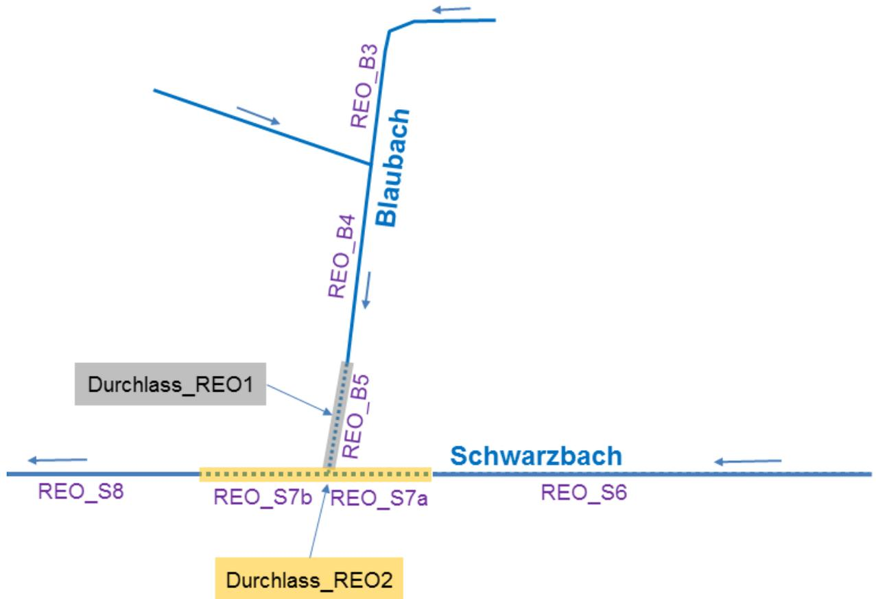
Abbildung 55: Modellierung eines linienförmigen Durchlasses
