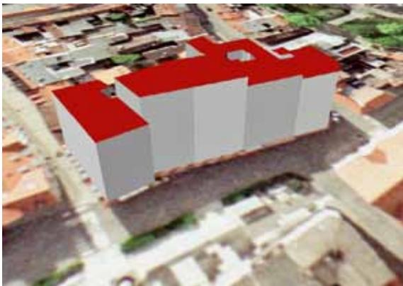
Abb. 9: level of Detail – LoD 1 (Klötzchenmodell ab 2013)
