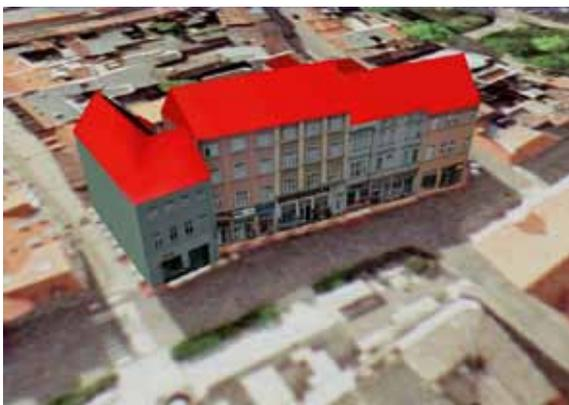
Abb. 10: Level of Detail – LoD 2 (Klötzchenmodell mit Standarddachform, geplant)
