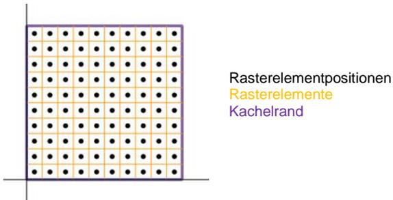
Abbildung 1: Schema der Anordnung von DGM Rasterelementen
