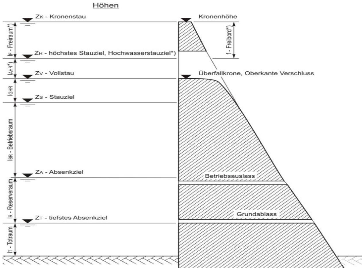
Abbildung 50: Schematische Darstellung der Stau- und Absenkeziele bei einem Stausee
