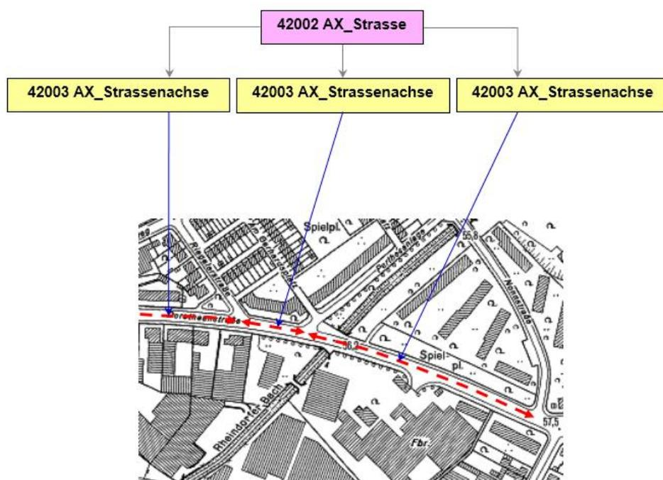
Abbildung 28: ZUSO AX\_Strasse besteht aus 3 REO AX\_Strassenachse
