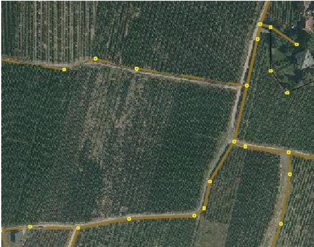
Abbildung 6: Beispiel für Lageabweichungen zwischen Modell und Örtlichkeit
