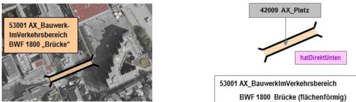
Abbildung 39: Modellierung einer flächenförmigen Brücke mit einem flächenförmigen Objekt
