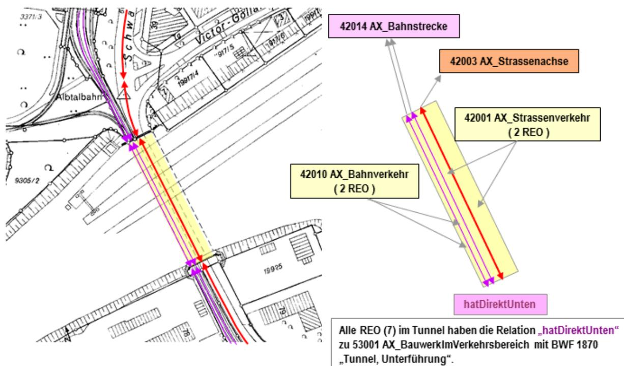
Abbildung 42: Modellierung eines flächenförmigen Tunnels mit mehreren Objekten
