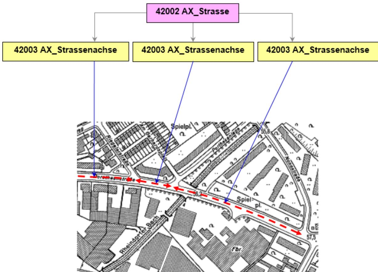
Abbildung 36: ZUSO AX\_Strasse besteht aus 3 REO AX\_Strassenachse
