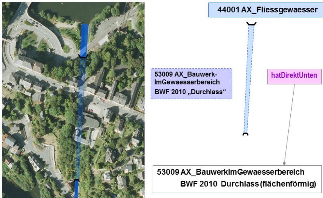
Abbildung 67: Modellierung eines flächenförmigen Durchlasses mit einem flächenförmigen Objekt
