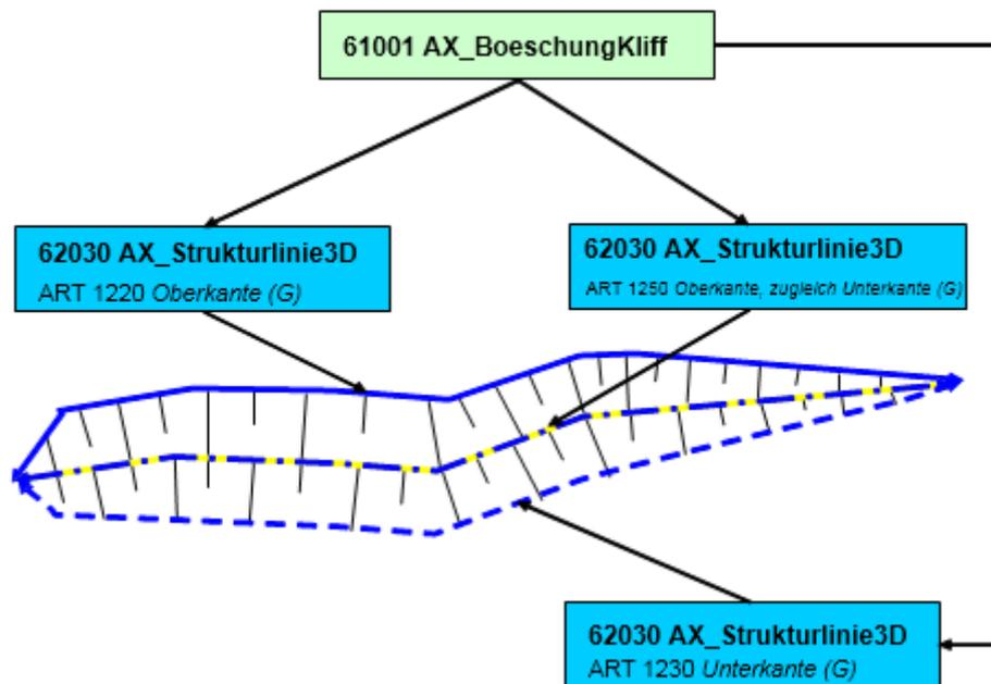
Abbildung 74: Modellierung einer Böschung mit Strukturlinien3D und Gefällewechsel
