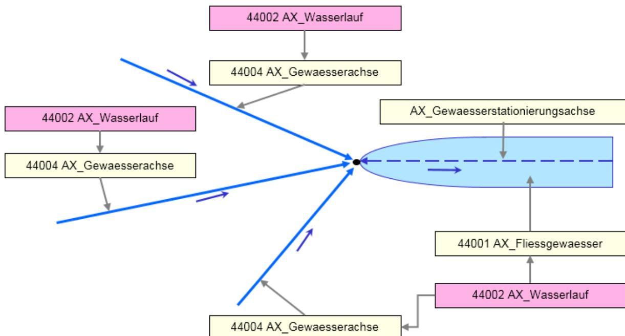
Abbildung 53: Modellierung von Wasserläufen unter Beachtung der Fließrichtung
