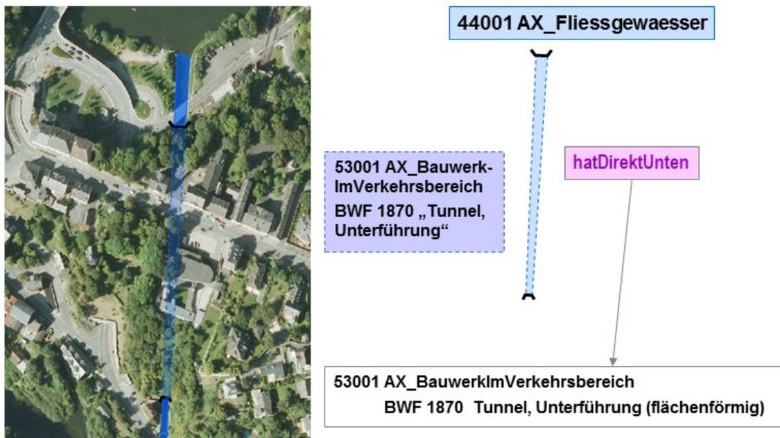
Abbildung 62: Modellierung eines flächenförmigen Tunnels mit einem flächenförmigen Objekt
