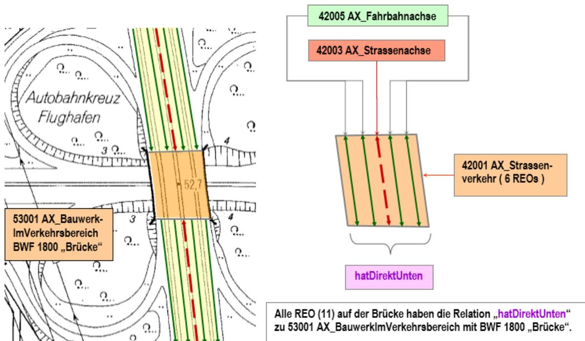
Abbildung 60: Modellierung einer flächenförmigen Brücke mit mehreren Objekten
