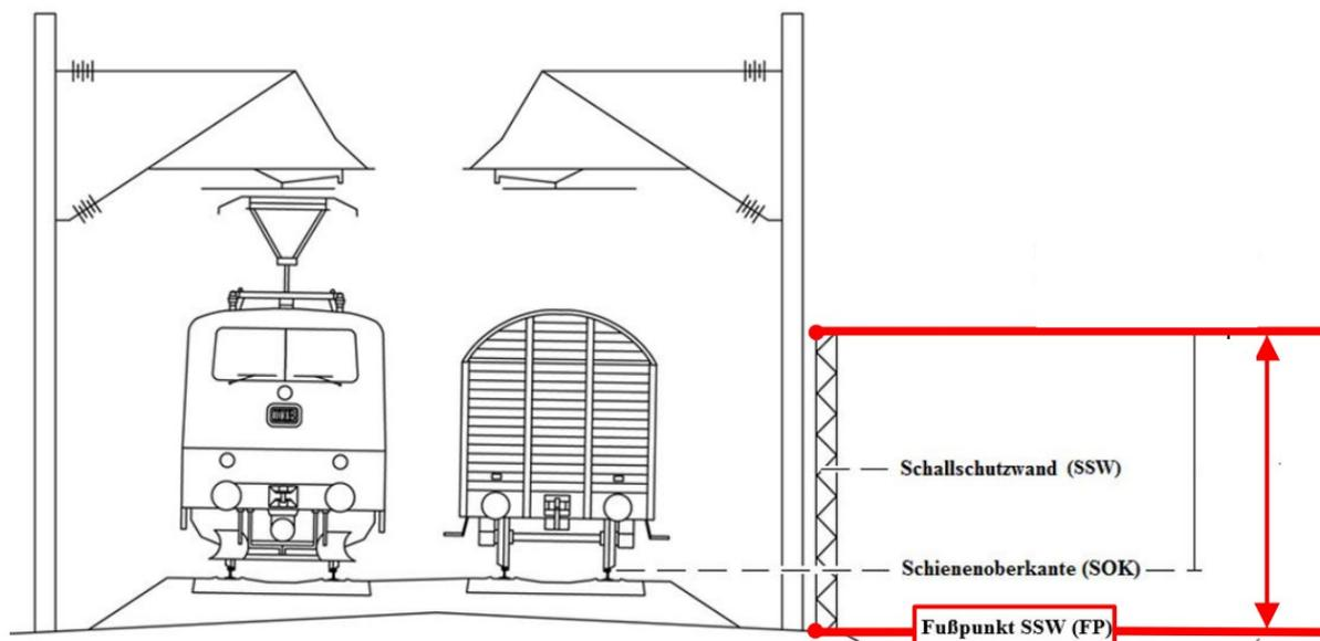
Abbildung 57: Höhenbezugspunkte für die Erhebung von Lärmschutzwänden
