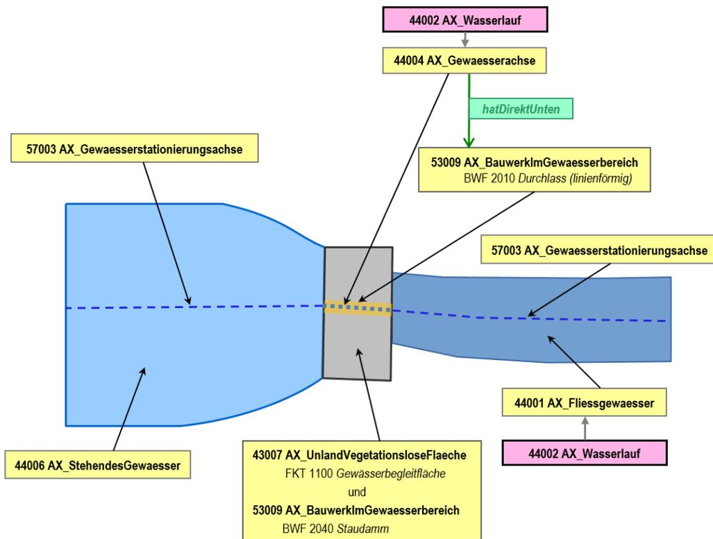
Abbildung 70: Modellierung von Wasserlauf unter Staudamm in linienförmigem Durchlass
