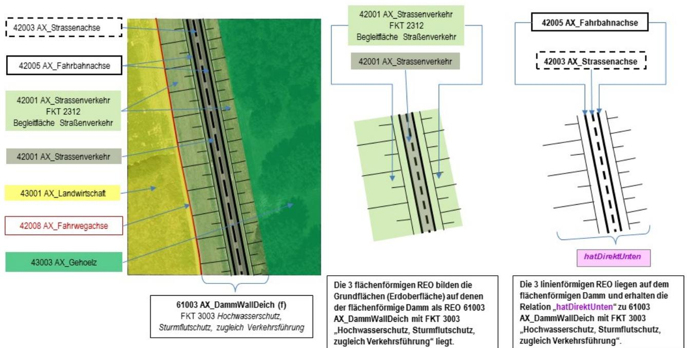
Abbildung 76: Modellierung eines flächenförmigen Dammes mit Straßen- und Fahrbahnachsen
