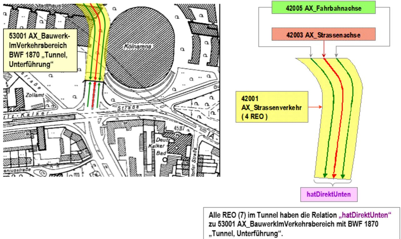
Abbildung 63: Modellierung eines flächenförmigen Tunnels mit mehreren Objekten
