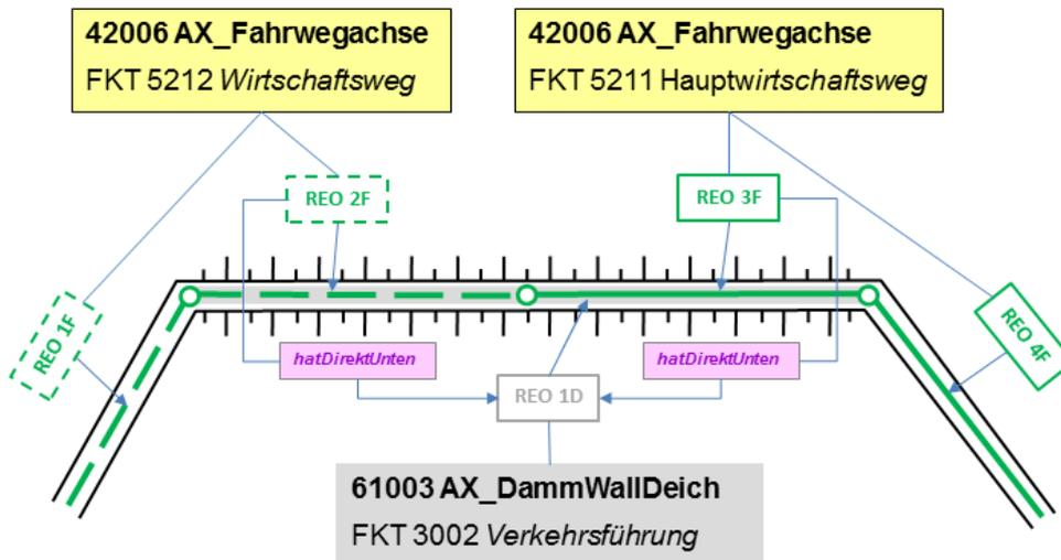
Abbildung 75: Modellierung eines linienförmigen Dammes mit mehreren Fahrwegachsen
