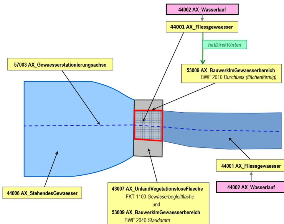
Abbildung 71: Modellierung von Wasserlauf unter Staudamm in flächenförmigem Durchlass
