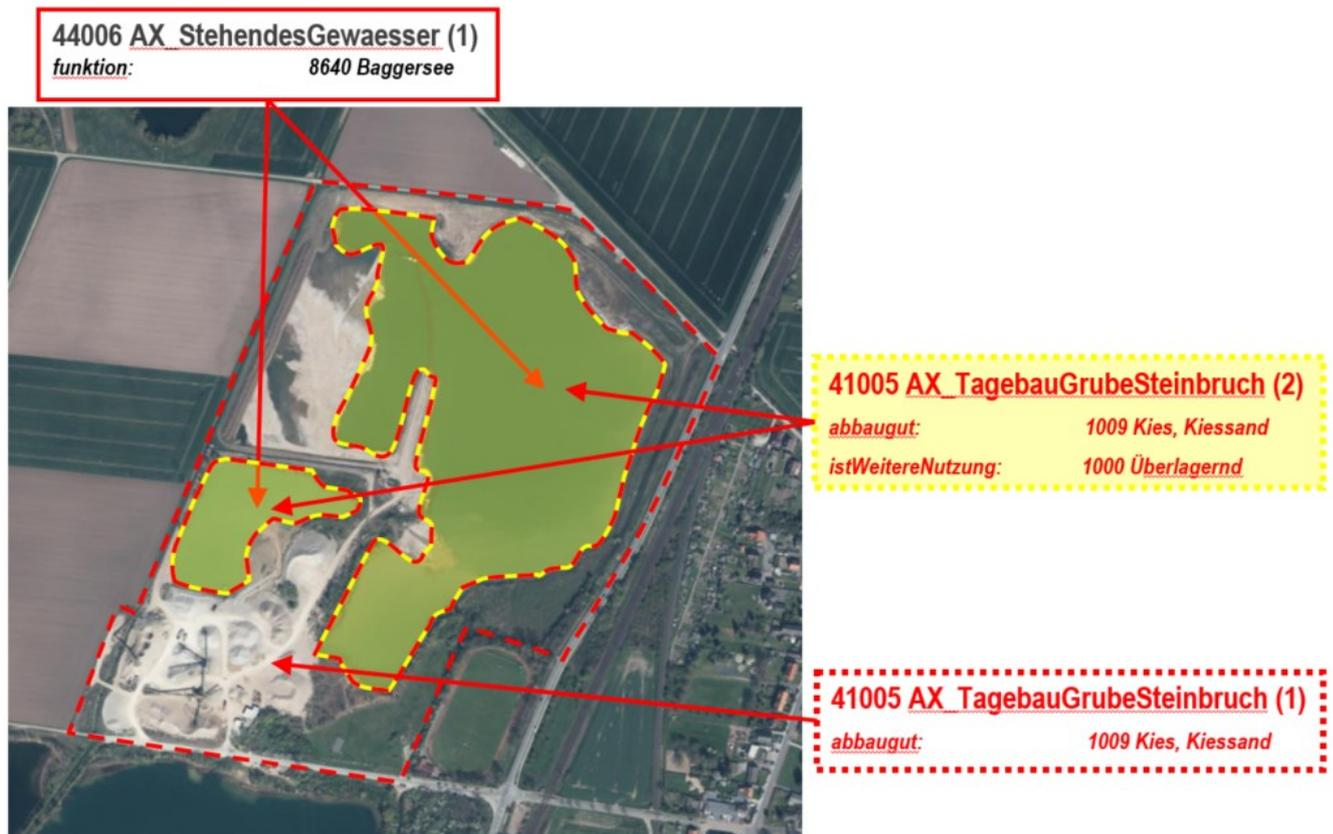
Abbildung 27: Anwendung des Attributes „istWeitereNutzung“ bei einem Tagebau
