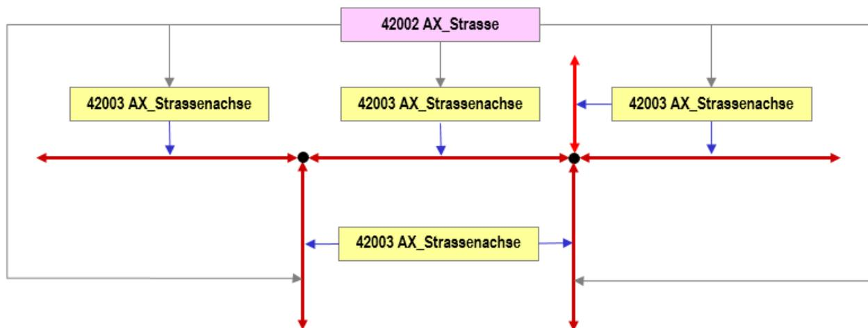
Abbildung 43: ZUSO AX\_Straße besteht aus 6 REO AX\_Strassenachse
