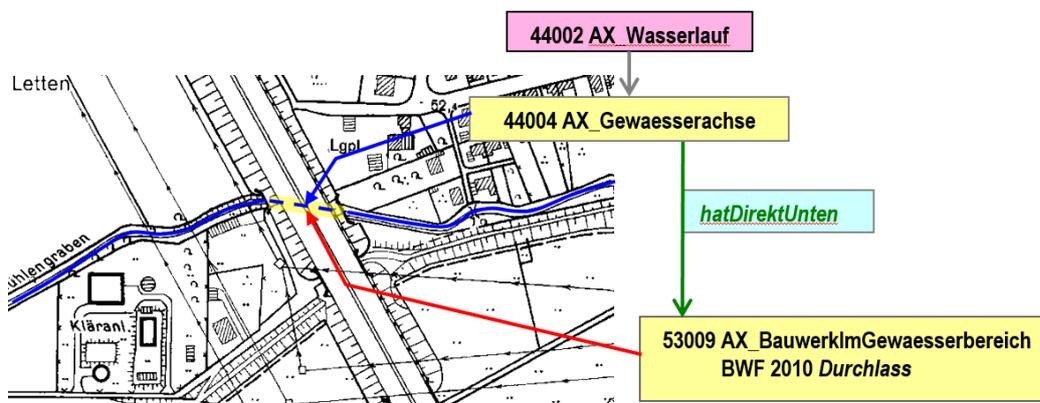
Abbildung 20: Beispiel für die Modellierung eines Durchlasses
