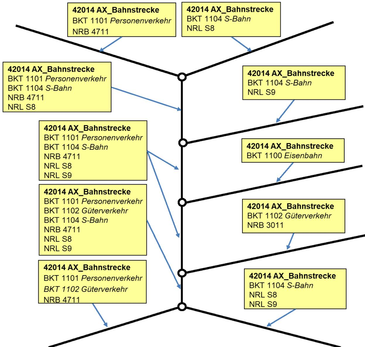
Abbildung 50: Modellierung von Bahnstrecken mit Strecken- und Liniennummern
