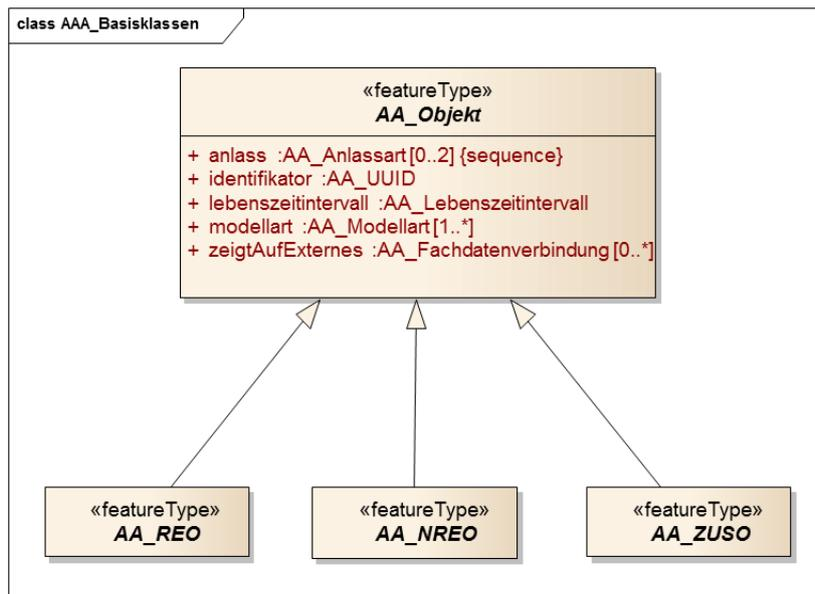
Abbildung 5: Modellierung der Basisklasse AA\_Objekt in UML
