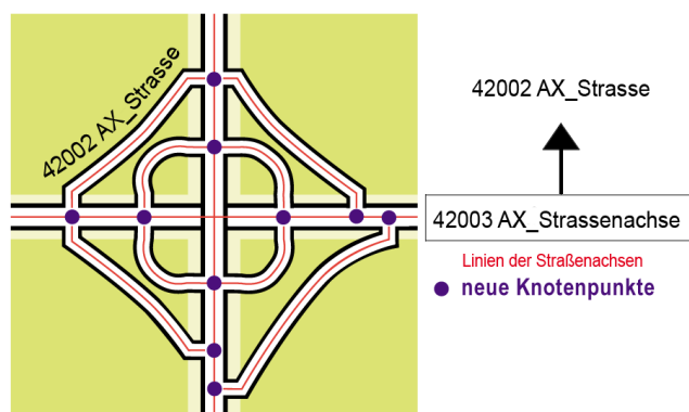
Abbildung 22: Herstellung der Topologie bei der Umwandlung von physisch getrennten zu einfach modellierten Straßen
