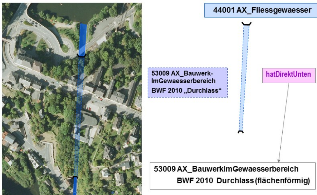
Abbildung 50: Modellierung eines flächenförmigen Durchlasses mit einem flächenförmigen Objekt
