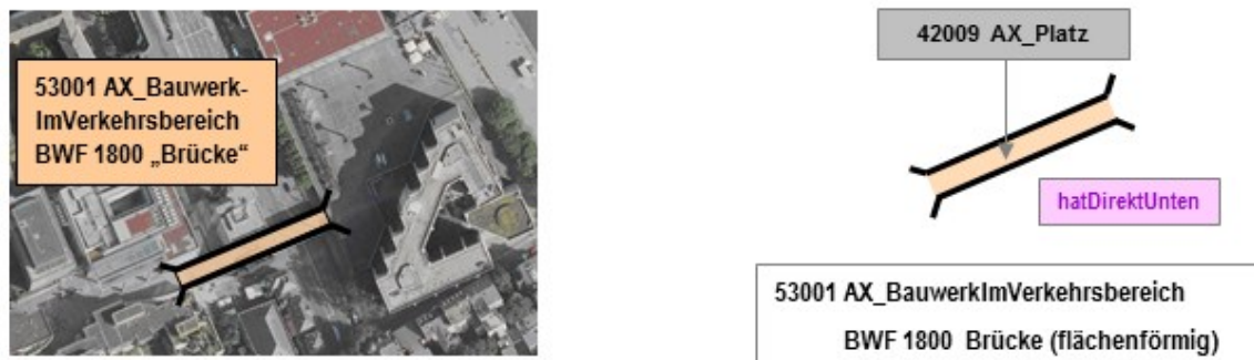
Abbildung 58: Modellierung einer flächenförmigen Brücke mit einem flächenförmigen Objekt
