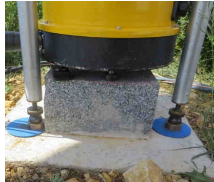
SFP/HFP-Pfeiler, Kopffläche 25x25 cm, (aufbetoniert für Absolutmessungen mit A10)
