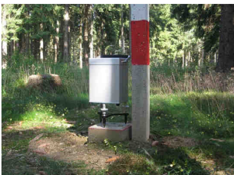
SFP-Pfeiler (für Relativmessungen)
