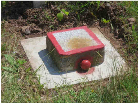
SFP/HFP-Pfeiler, Kopffläche 25x25 cm, (aufbetoniert für Absolutmessungen mit A10)
