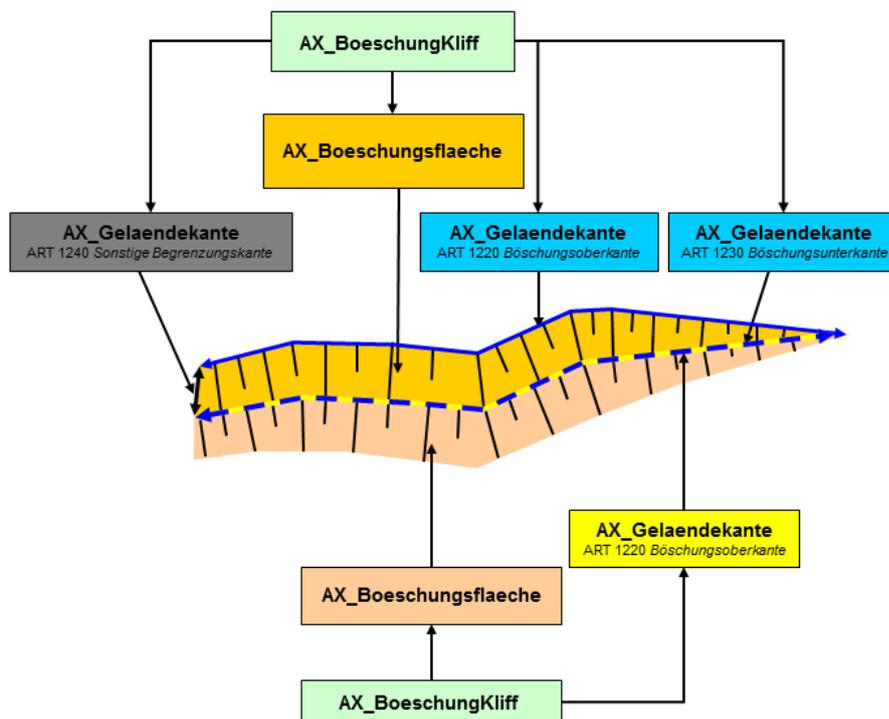
Abbildung 52: Modellierung von Böschungen mit Böschungsflächen und Geländekanten
