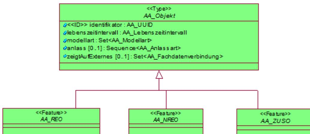
Abbildung 3: Modellierung der Basisklasse AA\_Objekt in UML
