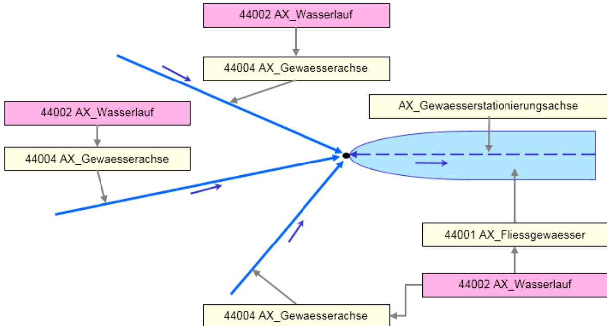
Abbildung 35: Modellierung von Wasserläufen unter Beachtung der Fließrichtung
