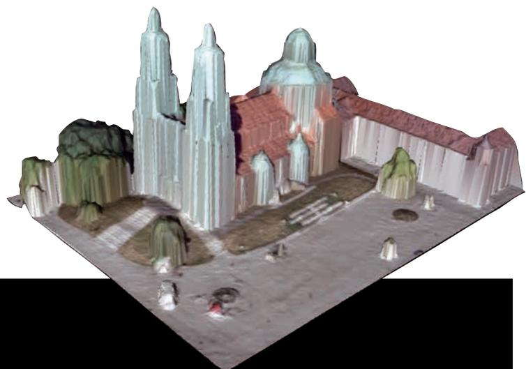
Abb. 21 (rechts): Digitales Oberflächenmodell, erstellt mithilfe von Image Matching
