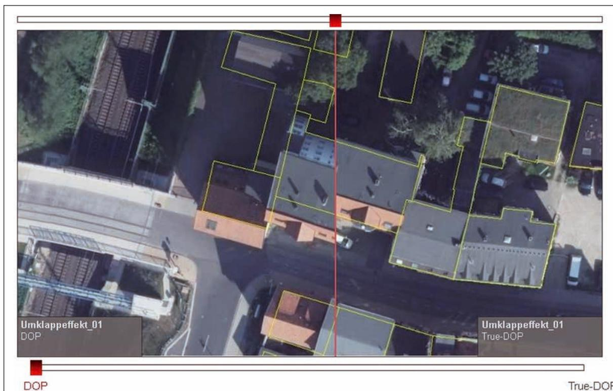
Abb. 25: Vergleichsansicht zwischen einem klassischen Orthophoto und dem entsprechenden TrueDOP an einem Beispiel aus Schwerin (Mecklenburg-Vorpommern)
