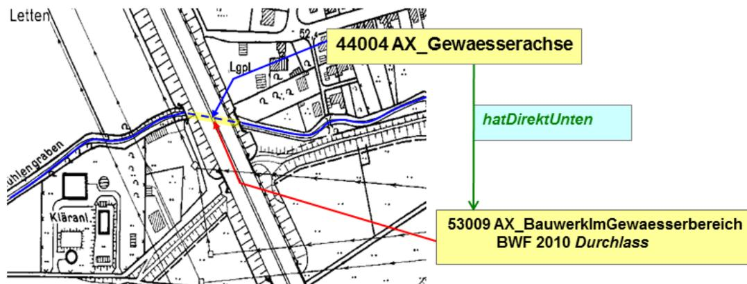
Abbildung 16: Beispiel für die Modellierung eines Durchlasses
