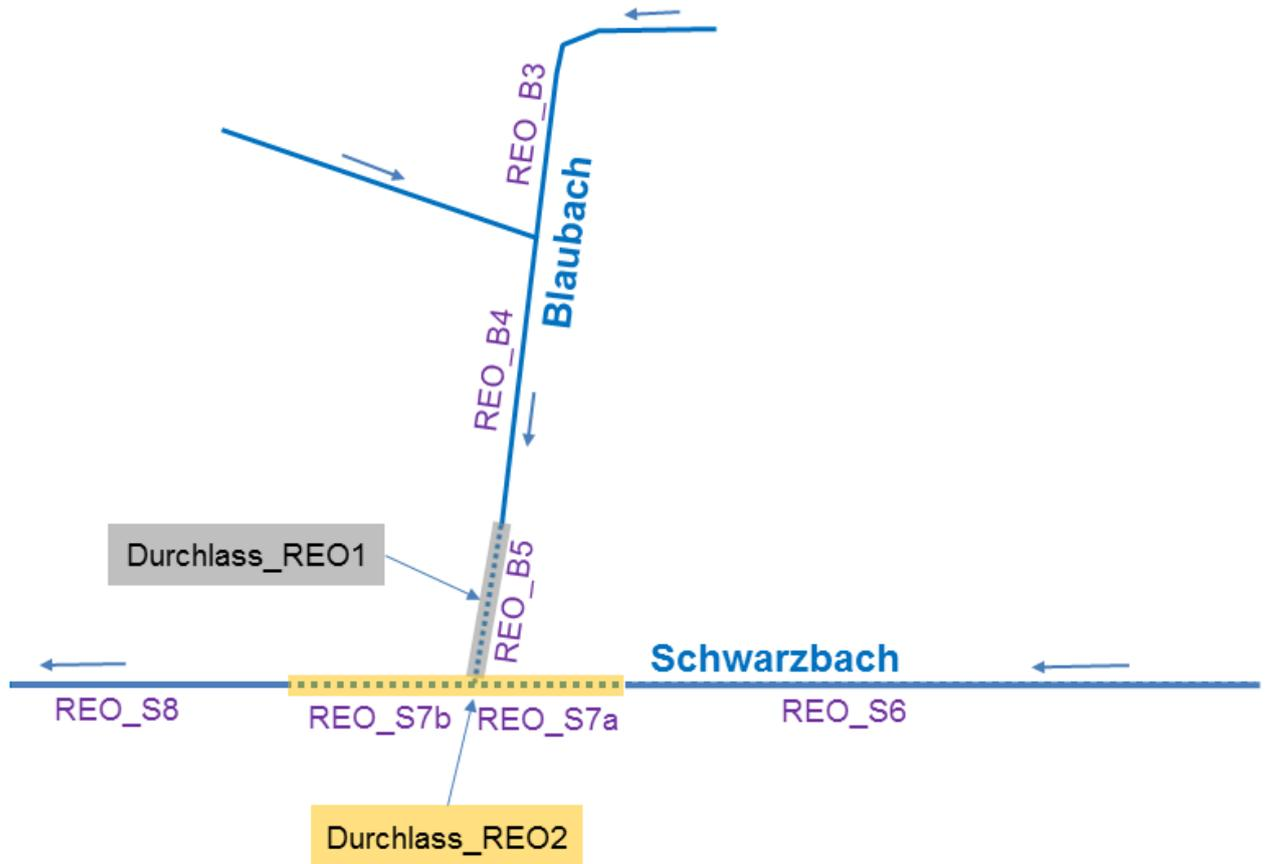
Abbildung 55: Modellierung eines linienförmigen Durchlasses
