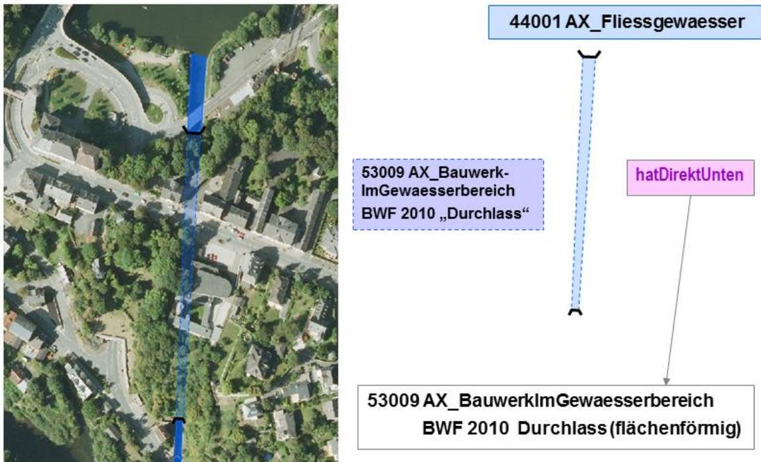
Abbildung 46: Modellierung eines flächenförmigen Durchlasses mit einem flächenförmigen Objekt
